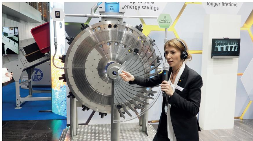
**Bild 2.** Das AMN-Schneidkopfsystem mit zentraler Wassereinspritzung von Maag sorgt für eine dauerhaft hohe Granulatqualität. © Hanser/Schröder
