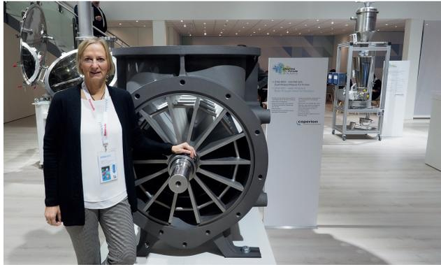
Material wird sehr gut durchmischt, dabei aber nur wenig belastet. Ein Pluspunkt für die Rezyklierung ist auch die hohe Entgasungsleistung der Doppelschneckenextruder. Außerdem erlaubt die gegenüber Einschneckenextrudern um ein Vielfaches bessere Oberflächenenergieerzeugung eine effiziente Geruchsreduktion und Entfeuchtung der Schmelze.“
