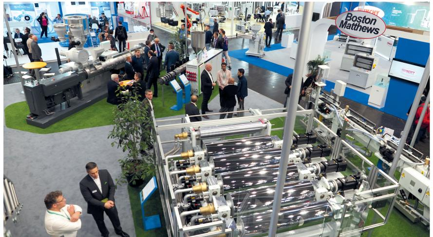
**Bild 4.** Blick auf den Stand von battenfeld-cincinnati: Im Vordergrund ist das horizontal angeordnete Multitouch-Glätzwerk zur Herstellung beidseitig geglätteter Dünnschichten zu sehen, das mit einer Leistung von bis zu 1200 kg/h aufwartet. © Hanser/Schröder
